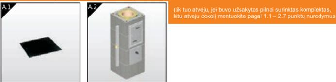
Ant paruošto betoninio pagrindo užtepkite sluoksnį hidroizoliacijos (pvz.: bituminės), ant kurio vėl suformuokite pagrindą iš cemento skiedinio.
